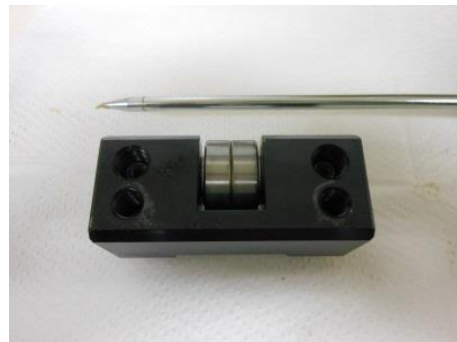
グリスニップル無の場合 先端が細くなっているノズル
