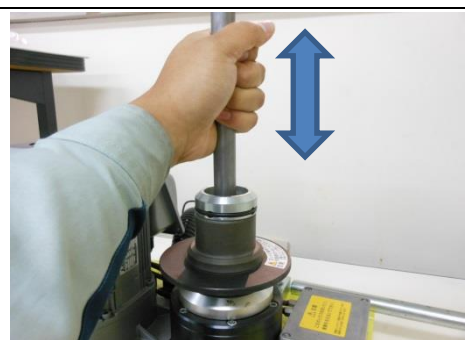
チャッキング状態確認
