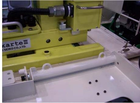
4) スタンドのペグ穴の位置にストッププレートを掛け、ペグを挿入します。
