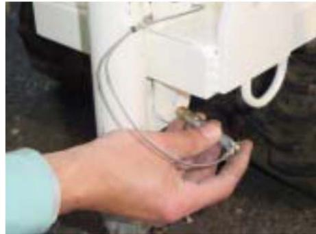
7) 制御装置とジオカルテ本体をメインケーブルで接続し、貫入試験手順に従って、試験を行ってください。
